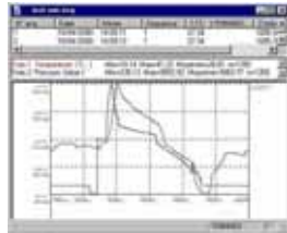
スプレー缶を加熱した際の温度と圧力 (スプレー缶の輸送時の温度変化に 応用できる)
